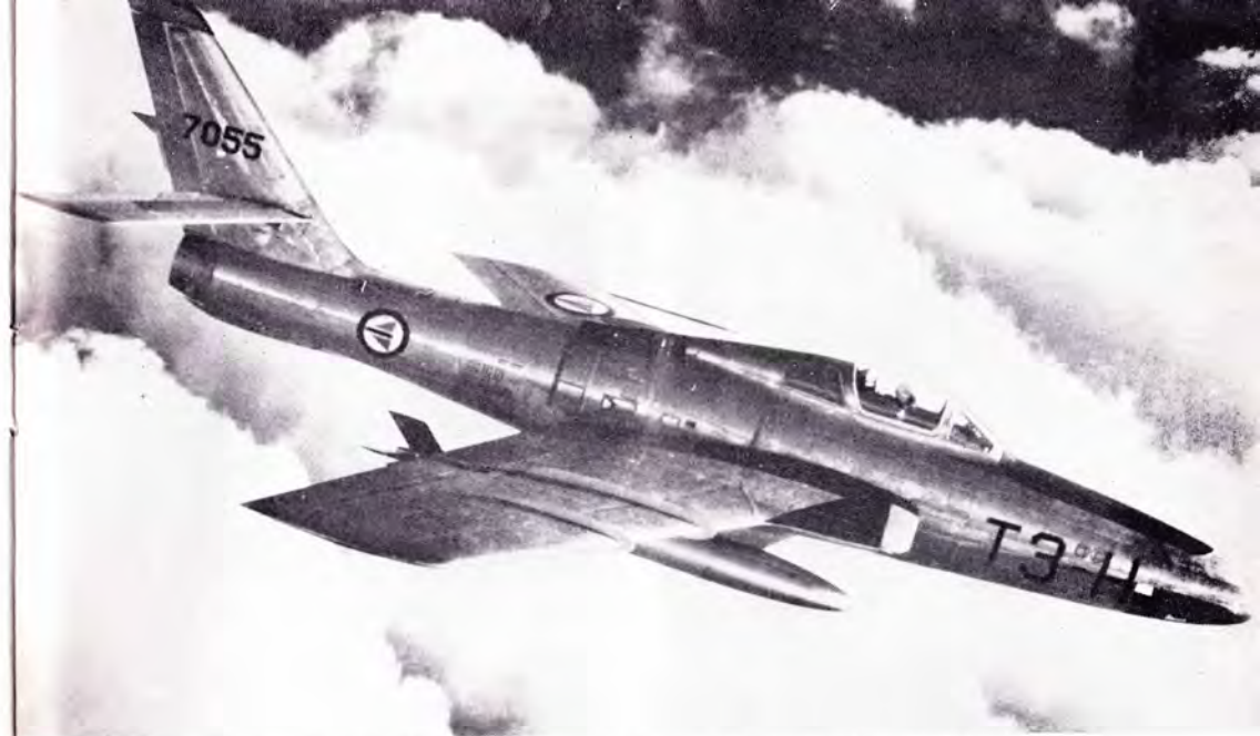
RF-84 F - Thunderflash -fotofly. I løpet av få timer kan skvadron 717 som har disse fly, fotografere størsteparten av Norge. Foruten kameraer kan flyet føre kanoner. I stup kan RF-84 F passere lydmuren.
